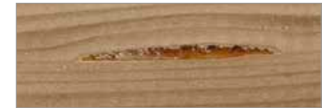
Harzgallen mit Entharzer entfernen
